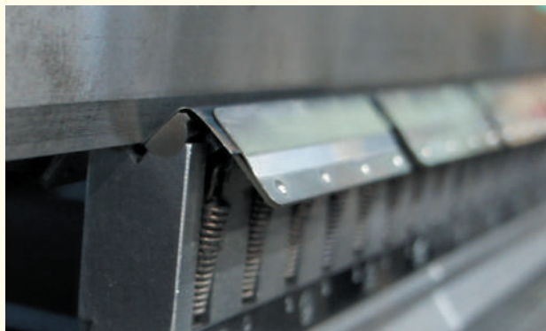
半円形の金型が回転して傷を防止 ダイに「ばね」が入ってます！
